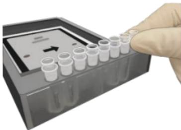
**图 3-1: 加载样品的放置**
