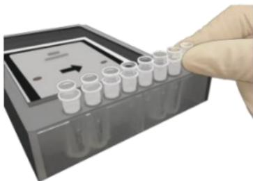
图 3-3: 加载样品的放置
