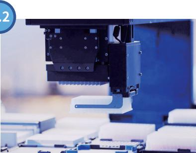
> 移液模块:移板机械夹爪
